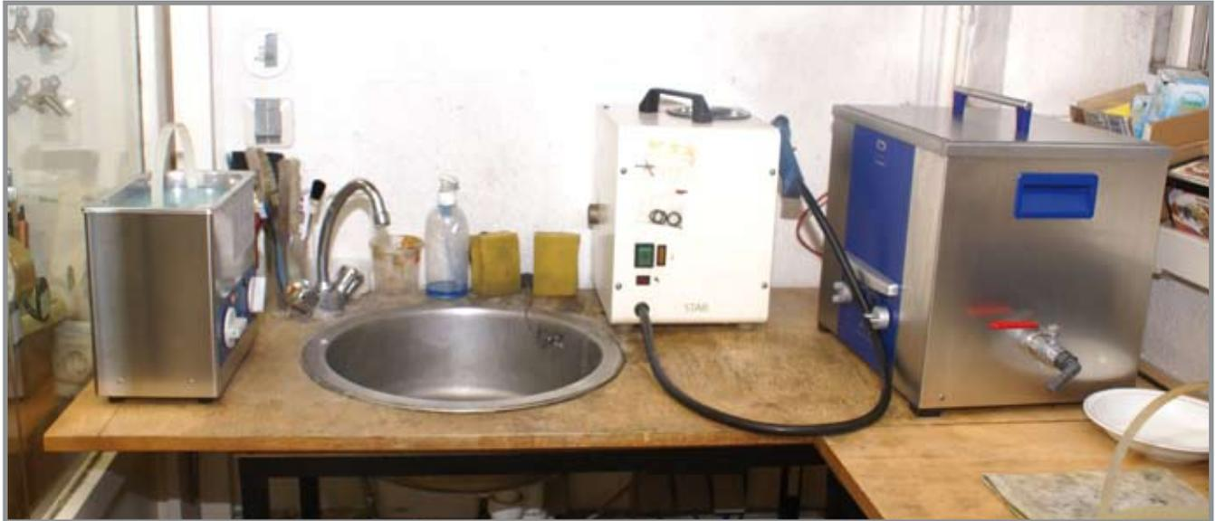
Hausintern wird dieser Bereich die „Nasszelle“ genannt, da hier alle Arbeiten ausgeführt werden, für die Feuchtigkeit benötigt wird. Dazu stehen zwei Ultraschallbäder zur Verfügung. Im
