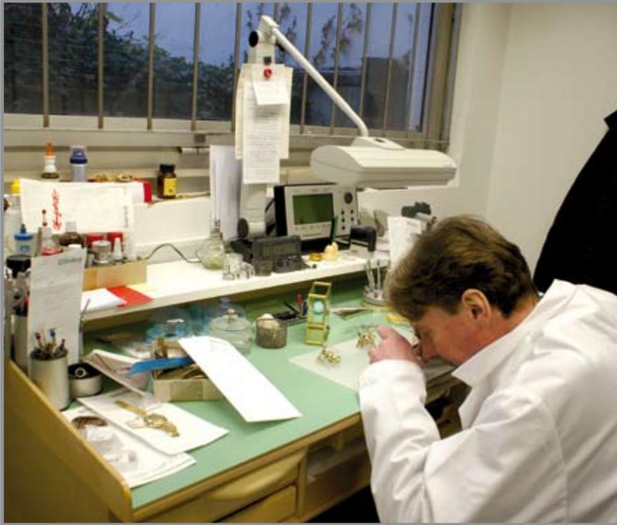
Die Ausstattung der Uhrmachertische der Werkstatt lässt keine Wünsche offen. An ihnen lassen sich alle Arbeiten an Groß- und Kleinuhren durchführen. Die Witschi Wicometre Professional Zeitwaage ist ausschließlich für die Gangmessung von mechanischen Werken eingerichtet. Gearbeitet wird zudem mit Druckluft statt mit Unterdruck. Der gleichmäßigere Druck ermöglichte ein im Vergleich mit Unterdruckgeräten genaueres Arbeiten, meint Stefan Schramm.
