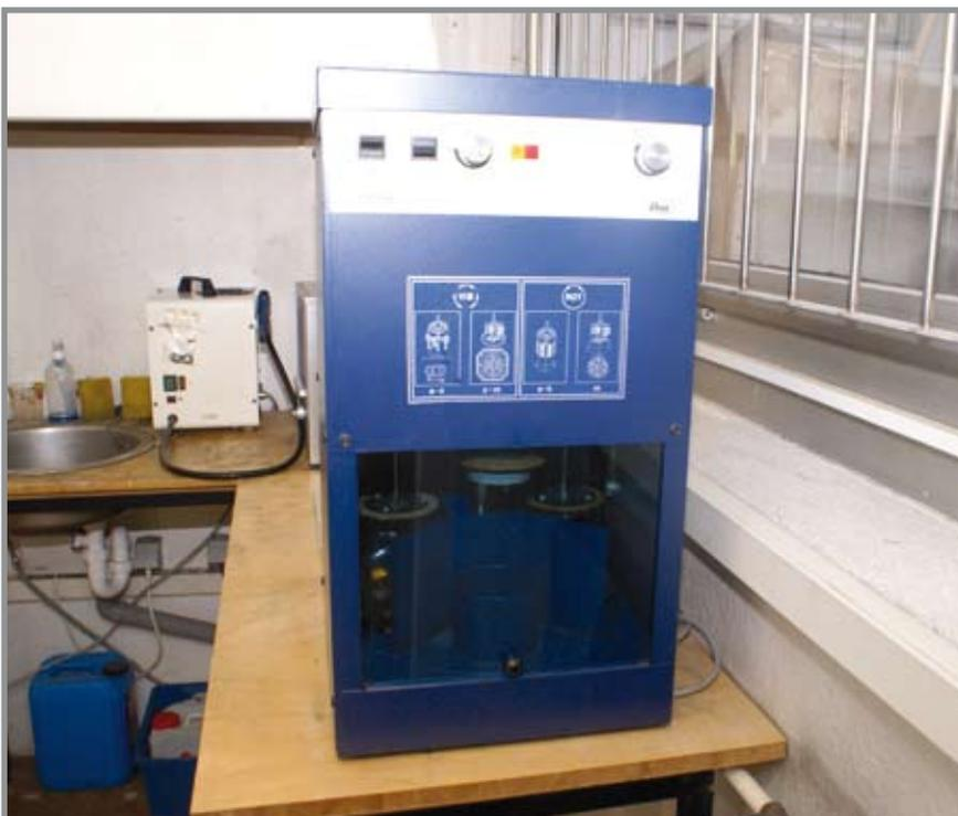
Ebenfalls Teil der „Nasszelle“ ist die Elma RM 90, mit der alle Werkteile einer Armbanduhr gereinigt werden. Schramm legt dabei Wert darauf, dass alle Teile in Handarbeit sorgfältig zerlegt und anschließend ebenfalls händisch wieder geschmiert werden. Eine automatische Schmierung findet in keinem Fall statt.
