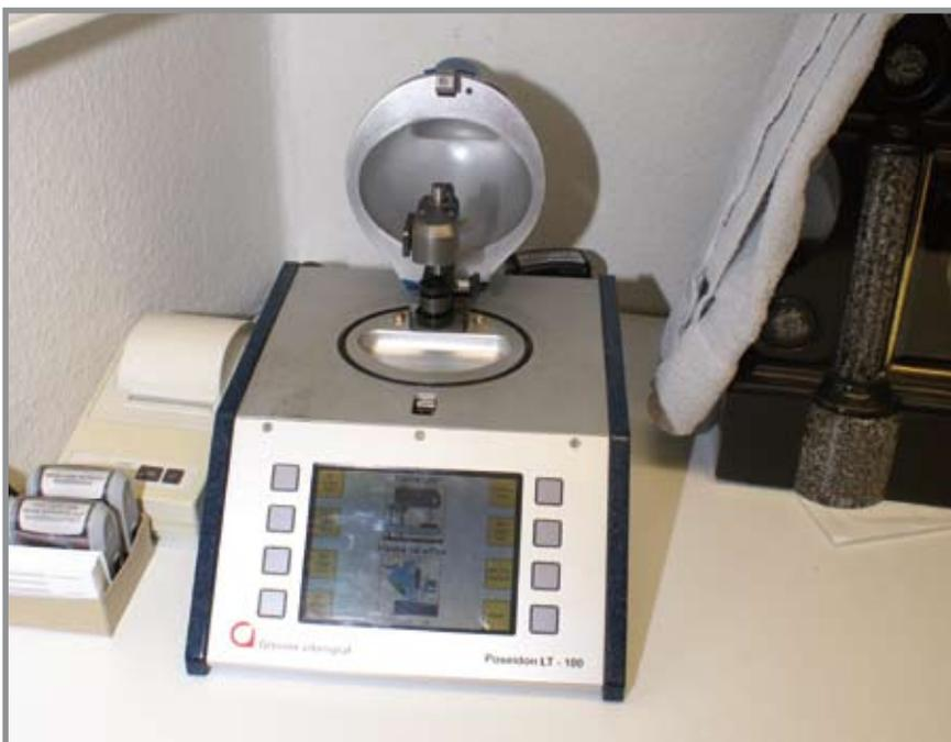
Zur Prüfung der Druckfestigkeit dient ein Greiner Poseidon LT-100. Das Gerät kann Uhren bis zu einem Druck von zehn Bar aussetzen und so deren Dichtigkeit prüfen. Stefan Schramm hält das für ausreichend. Geräte, die auf größeren Druck testen können, müssten regelmäßig vom TÜV geprüft werden.
